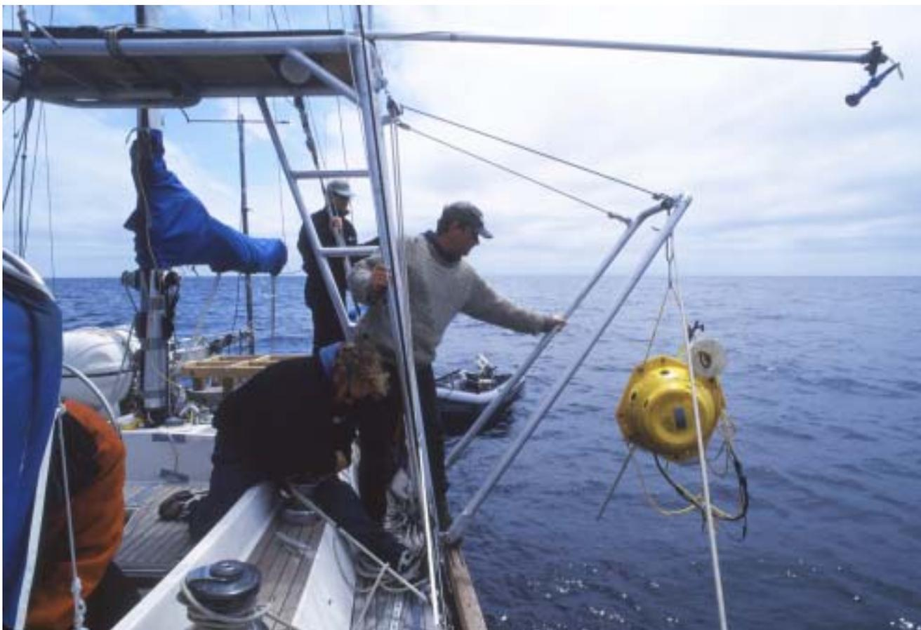
IFAW 鲸之歌号科考船船长，探身安放声控浮标。此浮标可根据露脊鲸发声监测到它们的行踪。
