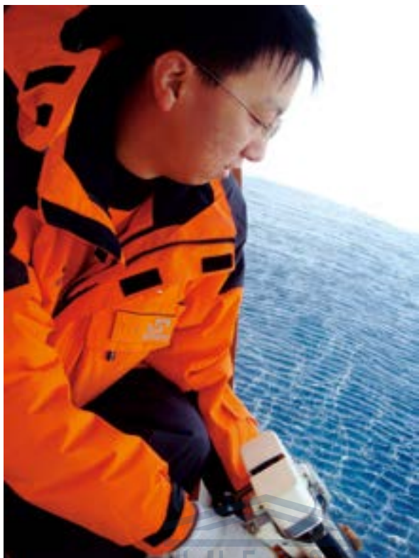
作者在埃默里冰架前缘海域，从直升机上空投 XCTD
