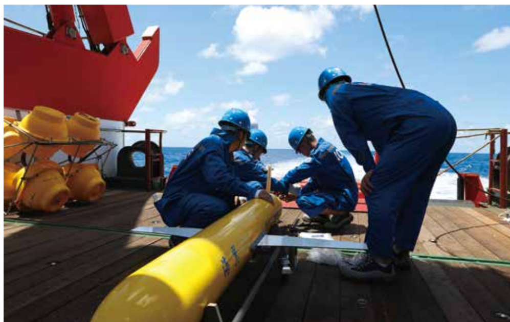
由中科院沈阳自动化所研制并具有完全自主知识产权的“海翼”号水下滑翔机。2017年，其最大下潜深度达6329米，是当时世界上安全下潜深度最大的同类装备。水下滑翔机是一种通过调节自身浮力和姿态以实现水中滑行并收集水体信息的新型水下机器人，其功耗低且静音能力强，可对特定海域开展高精度大范围观测，是现有水下观测手段的有效补充。供图 / 中国科学院
