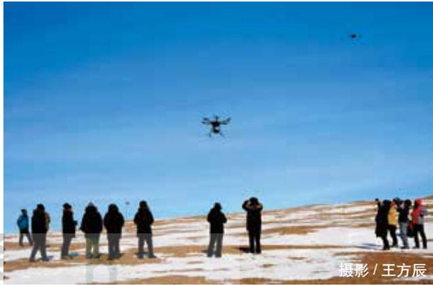
研究人员调查中发现藏野驴经常分布在距离样线几百米至几千米的区域。人为接近会惊走它们，而通过无人机调查可以在基本不惊动藏野驴的情况下完成对其个体的计数。在藏野驴的核心生境，遥控无人机进行“之”字形飞行，镜头垂直向下，监测区域覆盖整个区域（一般是藏野驴密集分布的山谷或者有藏野驴分布的山坡两侧）。经过若干次尝试，以不惊动藏野驴而又能清晰识别动物为原则，无人机的飞行高度确定为40米。
